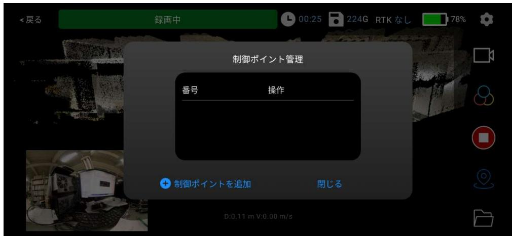
制御点を収集するには、位置決めプレートのアクリル板の中心を制御点位置に合わせ、「制御点を追加」をクリックする必要があります。機器を約 10 秒間安定させて収集を完了します。収集が完了すると「制御点の追加に成功しました。」と表示され、同様の手順で次の制御点を収集できます。
