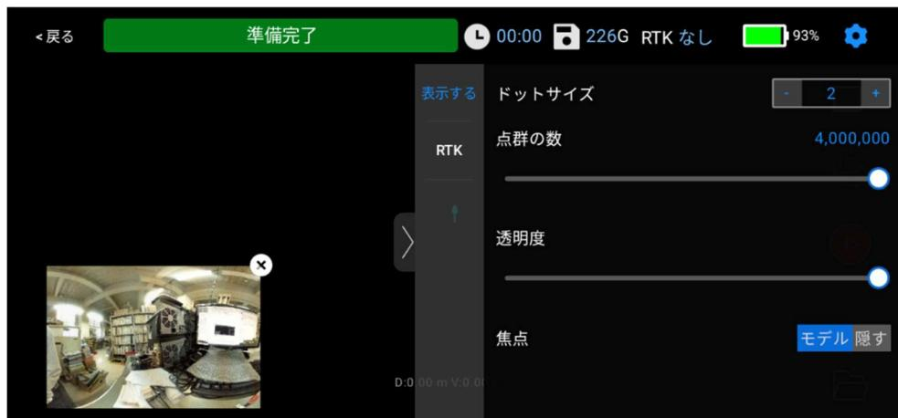
アプリケーションインターフェース右上の設定ボタン「
