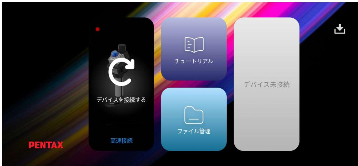
まず、スマートフォンの Bluetooth をオンにしてください。機器に初めて接続する場合は、「デバイスを接続する」ボタンをクリックし、ポップアップ表示されるデバイス検索のリストで PENTAX HS-X1 のシリアル番号を選択してください。
