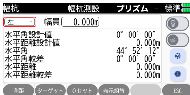
図 8.3-9 杭打ち位置指定
