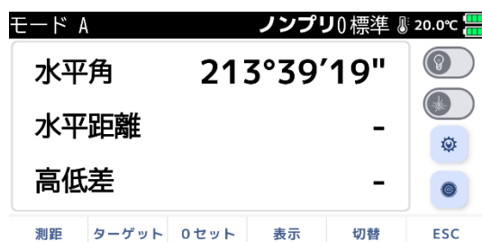
図 4.1-1 水平角/水平距離/高低差
