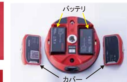
Li-ionバッテリ(BP09)を2個搭載。ホットスワップ対応で観測中でも交換が可能です。
