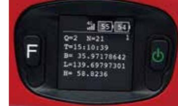
ネットワーク接続状況、バッテリの残量、衛星の数、位置情報が表示されています。
