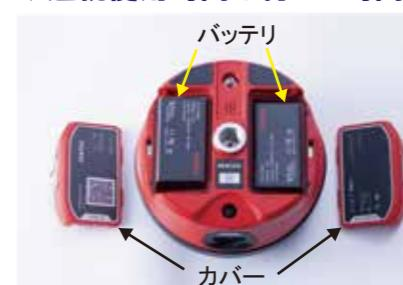
Li-ionバッテリ(BP09)を2個搭載。ホットスワップ対応で観測中でも交換が可能です。
