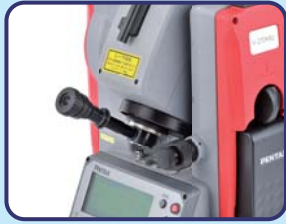
エルボアイピース SB12 天頂付近の観測あるいは制限された場所での測定に使用します。
