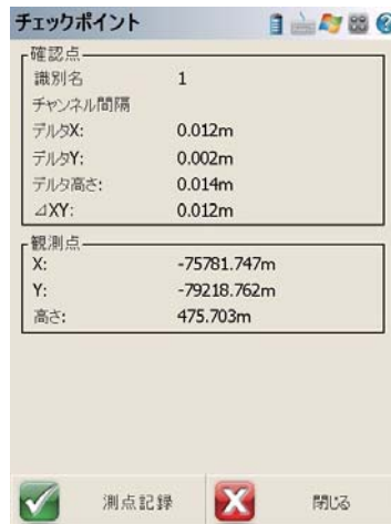
同一点を2回観測した際の 較差表示が可能です。 点名を変えて、座標値を保存することもできます
