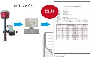
コントローラで記録した GNSS 受信機からの RTK 観測データを使い 手簿・記簿を出力・印刷するソフトウェアです。
